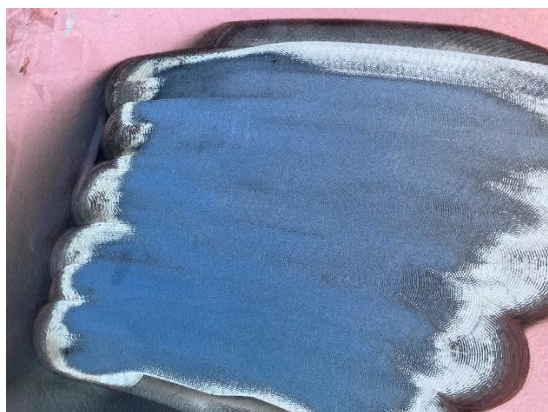
船舶外板へのレーザー施工部(拡大)
